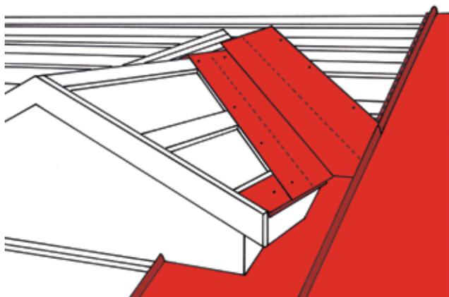
Прижмите слой уплотнителя к листу кровельного покрытия, чтобы угловой лист ендовы закрывал его. Сначала закрепите лист ендовы с помощью саморезов. Прижмите вертикальную кромку листа кровельного покрытия на расстоянии нахлеста. Более подробную информацию по монтажу внахлест можно найти в разделе Нарастивание листов кровельного покрытия (стр.14).
