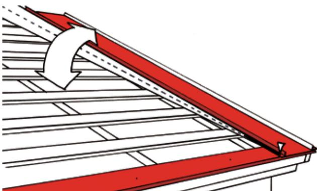
Сторона C подгоняется под размер за счет поворота листа металлочерепицы вокруг точки фиксации. Как только расстояние будет равно 5 метрам, значит, лист уложен под прямым углом к карнизной планке. Закрепите лист вдоль замочной части к каждой доске обрешетки.
