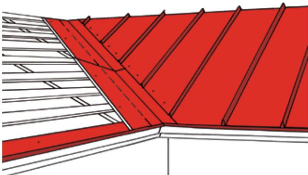
Смонтируйте обрезанные листы кровельного покрытия до верха ендовы. Рекомендуется наносить герметик под нахлесты листов кровельного покрытия на ендове. В процессе монтажа следите, чтобы угол ендовы совпадал с линией ориентира. При необходимости скорректируйте форму треугольного шаблона.
