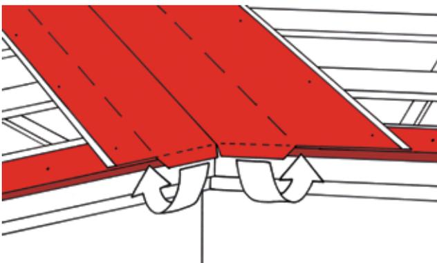
Отрежьте и придайте форму нижнему краю листу кровельного покрытия ендовы по линии выравнивания карнизов. Однако, края листа кровельного покрытия ендовы должны доходить до направляющих линий и выходить около 30 мм за карнизами. Загните эти края под накладку карниза.
