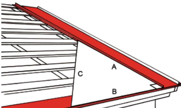
Будьте особенно внимательны при монтаже первого листа кровельного покрытия. Последующие листы будет проще монтировать, если первый лист уложить под прямым углом к карнизной планке. Прямой угол (90 градусов) можно определить с помощью прямоугольного треугольника, стороны которого имеют следующие размеры:
