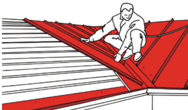
Измерьте, вырежьте и уложите оставшиеся листы кровельного покрытия по ендове. Соответствие листа шаблону можно проверить с помощью ориентиров, начерченных на обрешетке, или за счет измерения расстояния между следующим для монтажа листом и опорным листом. Также следите за углом ендовы и подгоняйте его при необходимости с помощью треугольного шаблона.
