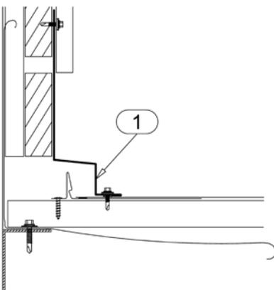
**Соединение кровли и стены, боковая стена, вертикальный разрез**
