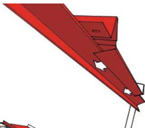
Листы кровельного покрытия монтируются строго вдоль карнизов. Первый лист необходимо уложить у правого края свеса кровли так, чтобы загиб у нижнего края листа заходил под кромку накладки карниза. Подтяните лист кровельного покрытия к коньку, чтобы кромка накладки карниза была снизу загиба листа.
