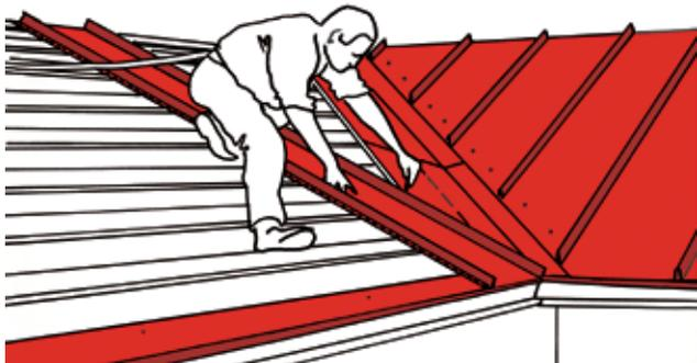
Смантируйте лист кровельного покрытия в качестве опоры в углу ендовы. Подгоните опорный лист кровельного покрытия к прямому углу. Более подробную информацию по подгонке опорного листа можно найти в разделе Монтаж кровли (стр.8). Закрепите опорный лист к обрешетке с помощью некоторого количества саморезов. Начертите ориентир на обрешетке вдоль края опорного листа.
