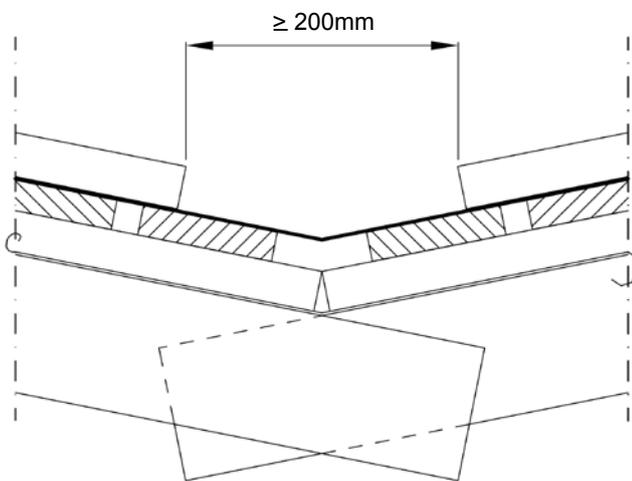
Минимальное расстояние между линиями (указывающих на место расположения листов кровельного покрытия) должно составлять 200 мм. Угловой лист ендовы должен заходить под лист кровельного покрытия минимум на 250 мм.
