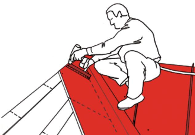
Проверьте, что угол треугольного шаблона был именно такой, какой необходим. Отрежьте первый лист кровельного покрытия необходимого размера и под необходимым углом. Закрепите лист у конька с помощью одного самореза.
