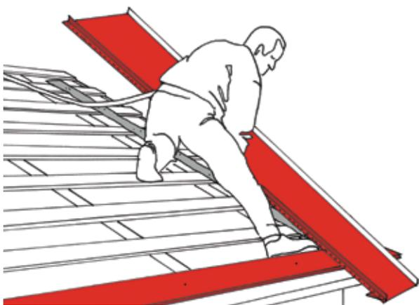
Смонтируйте шумоизоляционную ленту под каждый лист посередине листа. Шумоизоляционная лента должна быть уложена от второй планки снизу до второй планки сверху. Шумоизоляционная пленка предназначена для поглощения звуков, возникающих от ветра и дождя.
