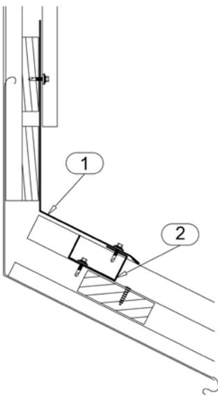
**Соединение кровли и стены, торцевая стена, вертикальный разрез**
