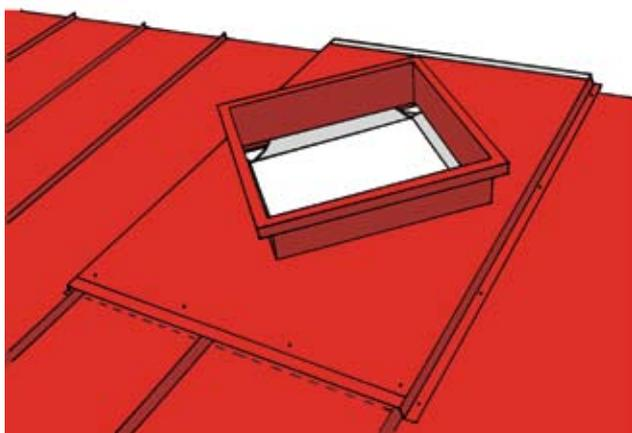
Примостите люк на место и закрепите стороны к листу кровельного покрытия с помощью саморезов (4 самореза/сторона). Закрепите верх и низ пожарного люка к опорной накладке с помощью саморезов (4 самореза с каждого края).
