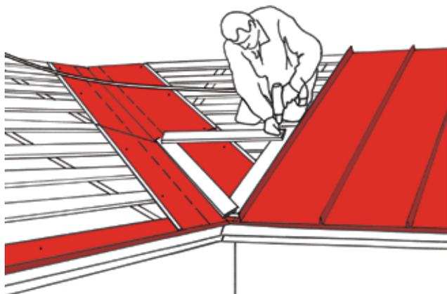
Смонтируйте листы кровельного покрытия до ендовы. Угол среза листов, которые будут уложены по ендове, можно определить, например, с помощью треугольного шаблона.
