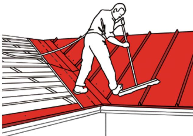
Смахните мягкой щеткой стружку, которая осталась на поверхности кровли от отрезания и сверления листов. Подкрасьте поверхность при необходимости.
