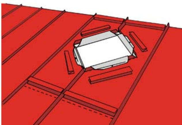
Сделайте поперечный разрез гидроизоляционного материала и загните полосы материала поверх кровельного покрытия. Закрепите полосы с помощью герметика или саморезов.
