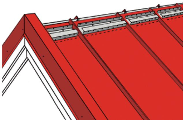
Смонтируйте карнизную накладку с противоположной стороны поверхности кровли.
