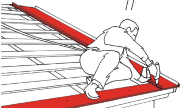
Сначала закрепите лист кровельного покрытия с помощью одного шурупа Classic в нижнем углу листа.
