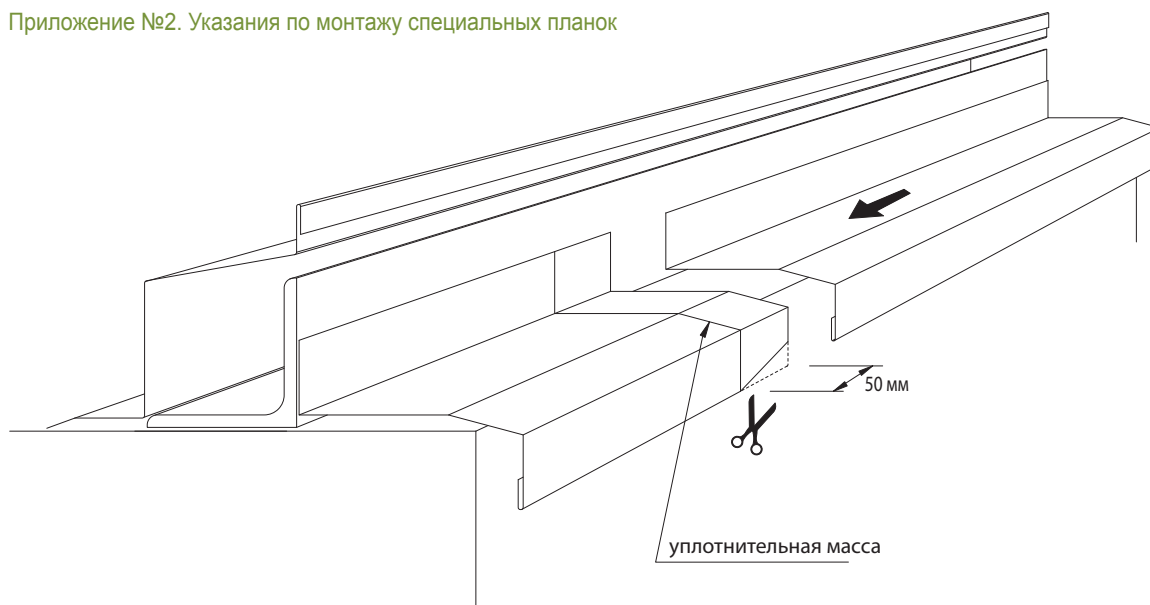
Рис. № 1. Соединение цокольных планок.
