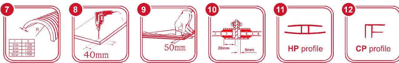
**Важно:** неразъёмные поликарбонатные профили HP и UP не являются монтажными и не предназначены для крепления к несущим конструкциям! Они служат лишь для соединения поликарбонатных листов между собой и герметизации стыка. Отвод воды, попадающей внутрь профиля в местах стыка панелей, производится по желобкам, предусмотренным в базовом соединительном профиле. Из них вода попадает в торцевой профиль, по которому выводится за пределы конструкции.
