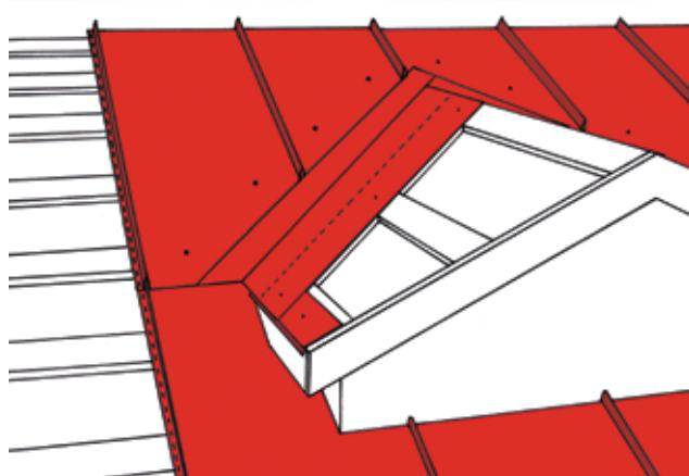
Начинайте монтаж листов от того листа, который был последним смонтирован на коньке слухового окна. Проверьте ровность шаблона укладки листов по ориентирам, намеченным на обрешетке. Завершите крепеж листов кровельного покрытия по ендове с помощью саморезов. Каждый лист закрепите с помощью двух саморезов, расположенных ровно на одну треть длины листа от каждого края.
