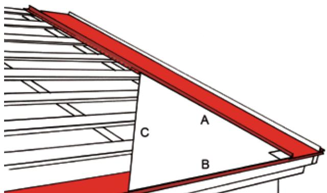
Будьте особенно внимательны при монтаже первого листа кровельного покрытия. Последующие листы будет проще монтировать, если первый лист уложить под прямым углом к карнизной планке. Прямой угол (90 градусов) можно определить с помощью прямоугольного треугольника, стороны которого имеют следующие размеры:
