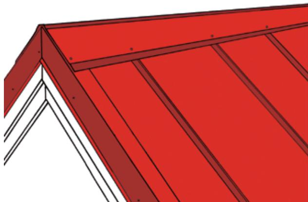
Установите коньковую накладку на место. Закрепите ее с помощью саморезов к вентиляционной накладке конька на расстоянии не более 1000 мм. Захлест на коньковую накладку должен составлять не менее 100 мм. Внимание: не закрепляйте части коньковой накладки между собой, это помешает тепловому расширению.
