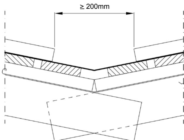
Минимальное расстояние между линиями (указывающими на место расположения листов кровельного покрытия) должно составлять 200 мм. Угловой лист ендовы должен заходить под лист кровельного покрытия минимум на 250 мм.
