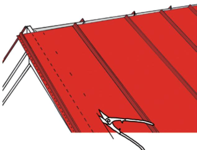
Начертите линию свеса кровли на том листе, который выступает за край. Отрежьте лист не по намеченной линии, а отступив на 50 мм от линии в направлении поверхности кровли.
