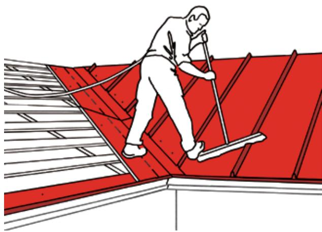
Смонтируйте листы кровельного покрытия до ендовой. Угол среза листов, которые будут уложены по ендовой, можно определить, например, с помощью треугольного шаблона.
