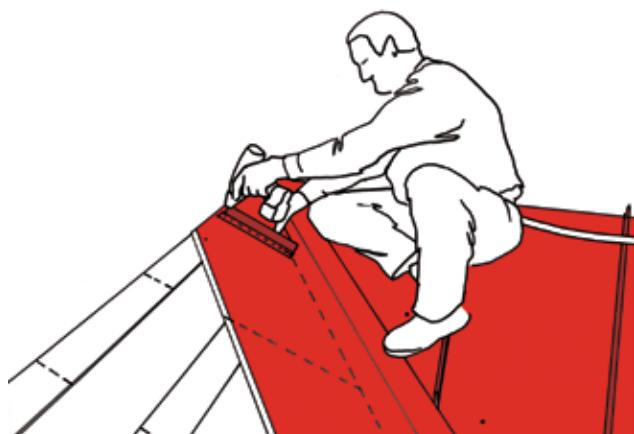
Проверьте, что угол треугольного шаблона был именно такой, какой необходим. Отрежьте первый лист кровельного покрытия необходимого размера и под необходимым углом. Закрепите лист у конька с помощью одного самореза.
