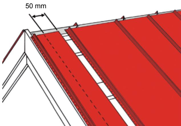
Сначала смонтируйте ту часть, которая выходила за край свеса кровли. При необходимости эту часть можно сделать уже. Закрепите ее с помощью нескольких саморезов.
