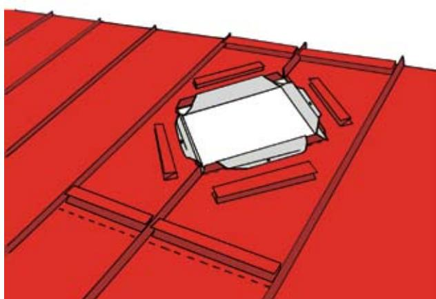
Сделайте поперечный разрез гидроизоляционного материала и загните полосы материала поверх кровельного покрытия. Закрепите полосы с помощью герметика или саморезов.
