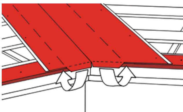
Отрежьте и придайте форму нижнему краю листу кровельного покрытия ендовы по линии выравнивания карнизов. Однако, края листа кровельного покрытия ендовы должны доходить до направляющих линий и выходить около 30 мм за карнизы. Загните эти края под накладку карниза.
