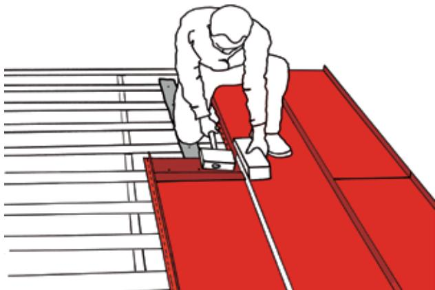
Используйте деревянный молоток, чтобы состыковать кромки обоих листов кровельного покрытия, по крайней мере, на расстоянии стыковой накладки RA1ACJ, для того, чтобы уменьшить размер стыка и верхний лист уложить на место.
