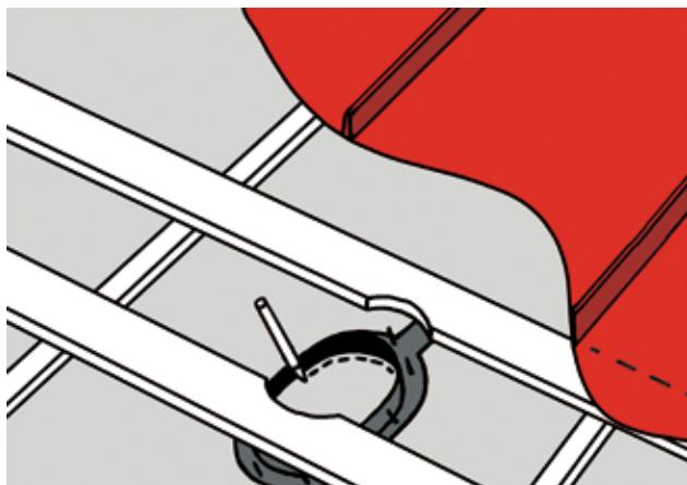
Уплотнитель гидроизоляции применяется, чтобы приподнять слой гидроизоляции и таким образом организовать отвод влаги через устройство вентиляции.
