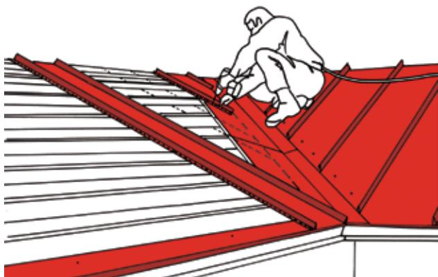
Как только соединенные листы будут выровнены относительно опорного листа, закрепите их с помощью саморезов.
