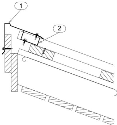
**Односкатная кровля, вертикальный разрез**
