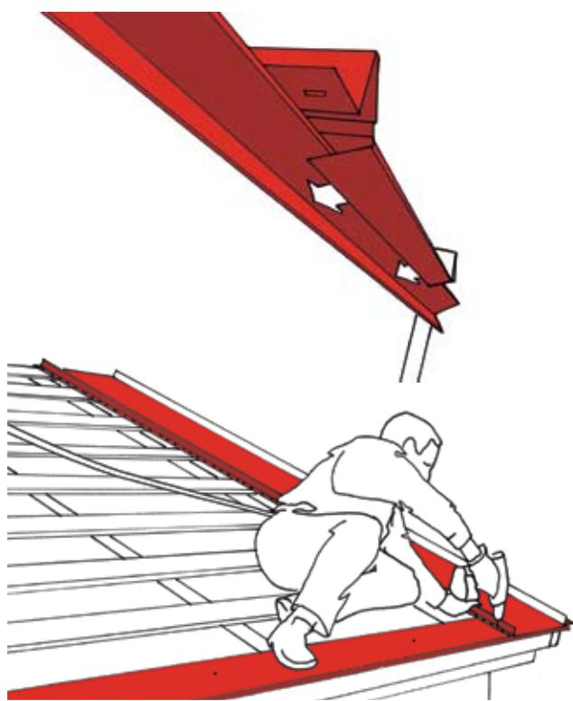
Листы кровельного покрытия монтируются строго вдоль карнизов. Первый лист необходимо уложить у правого края свеса кровли так, чтобы загиб у нижнего края листа заходил под кромку накладки карниза. Подтяните лист кровельного покрытия к коньку, чтобы кромка накладки карниза была снизу загиба листа.
