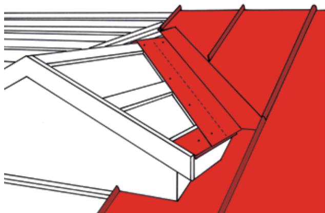
Смонтируйте листы кровельного покрытия до конька слухового окна. Последний лист не следует закреплять, необходимо просто прижать на месте по кромке. Лист не следует закреплять прежде, чем будет установлен другой лист ендовы слухового окна.
