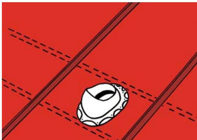
Прижмите верхнюю насадку на место. Закрепите верхнюю насадку к листу кровельного покрытия с помощью саморезов из комплекта поставки вентиляции. На упаковке комплекта можно найти более детальную информацию о порядке крепления. Не затягивайте шурупы слишком сильно. При сильной затяжке шурупов верхняя насадка может треснуть во время сильных морозов.
