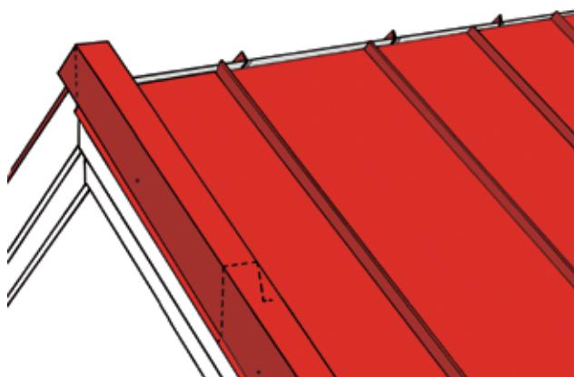
Уложите торцевую планку Classic на место. Отрежьте и придайте форму верхнему краю торцевой планки. Закрепите планку с помощью саморезов сквозь лист кровельного покрытия к обрешетке. Шаг крепежа должен составлять 400-600 мм (в зависимости от расстояния между досками обрешетки). Также закрепите планку к доске карниза через каждые 1000 мм. Торцевая планка должна быть уложена с нахлестом минимум 100 мм.
