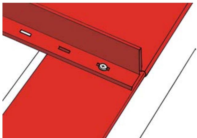
Закрепите лист приблизительно в середине отверстия. Саморезы, проходящие через накладку карниза, закрепляют накладку на своем месте.
