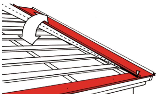
Сторона С подгоняется под размер за счет поворота листа металлической панели вокруг точки фиксации. Как только расстояние будет равно 5 метрам, значит, лист уложен под прямым углом к карнизной планке. Закрепите лист вдоль замочной части к каждой доске обрешетки.
