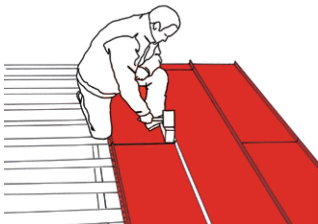
Забейте (с помощью деревянного молотка) внутренние уголки листа вниз около стыка, чтобы обе кромки листов кровельного покрытия зацепились в замок.
