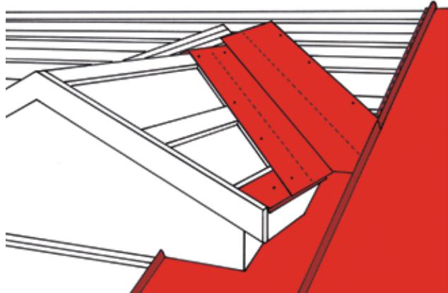
Прижмите слой уплотнителя к листу кровельного покрытия, чтобы угловой лист ендовы закрывал его. Сначала закрепите лист ендовы с помощью саморезов. Прижмите вертикальную кромку листа кровельного покрытия на расстоянии нахлеста. Более подробную информацию по монтажу внахлест можно найти в разделе Наращивание листов кровельного покрытия (стр.14).
