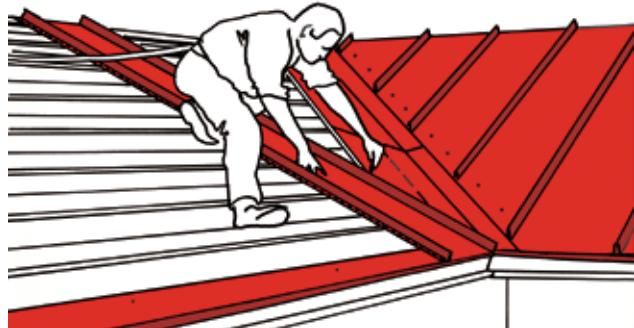
Смантируйте лист кровельного покрытия в качестве опоры в углу ендовой. Подгоните опорный лист кровельного покрытия к прямому углу. Более подробную информацию по подгонке опорного листа можно найти в разделе Монтаж кровли (стр.8). Закрепите опорный лист к обрешетке с помощью некоторого количества саморезов. Начертите ориентир на обрешетке вдоль края опорного листа.
