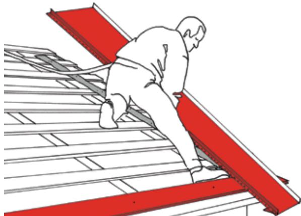
Смонтируйте шумоизоляционную ленту под каждый лист посередине листа. Шумоизоляционная лента должна быть уложена от второй планки снизу до второй планки сверху. Шумоизоляционная пленка предназначена для поглощения звуков, возникающих от ветра и дождя.
