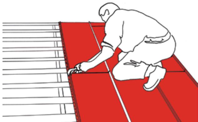
Осторожно зажмите обе кромки с помощью пассатижей. Закрепите лист. Удалите защитную пленку с кромки.
