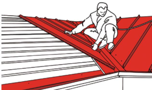
Измерьте, вырежьте и уложите оставшиеся листы кровельного покрытия по ендove. Соответствие листа шаблону можно проверить с помощью ориентиров, начертанных на обрешетке, или за счет измерения расстояния между следующим для монтажа листом и опорным листом. Также следите за углом ендовы и подгоняйте его при необходимости с помощью треугольного шаблона.
