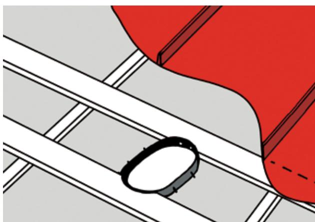
Продавите штыри уплотнителя в слой гидроизоляции. Зажмите герметик между уплотнителем и гидроизоляцией. Приподнимите слой гидроизоляции к нижней поверхности обрешетки с помощью уплотнителя. Закрепите уплотнитель гидроизоляции к обрешетке с помощью шурупов.
