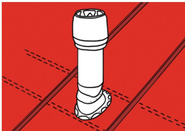
Установите устройство выхода на верхнюю пластину. Сначала закрепите его с помощью одного самореза. Смонтируйте элемент вертикально, используя ватерпас.
