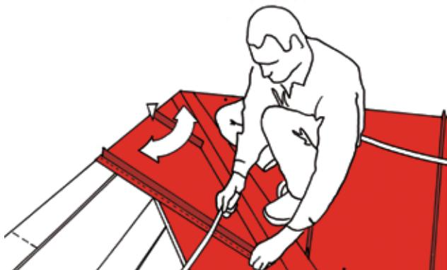
Измерьте расстояние до опорного листа от нижней части кромки и от верхней. Подгоните расстояние по нижнему краю в соответствии с верхним за счет поворота соединенных листов вокруг крепежного шурупа.
